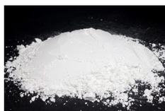
Solfato di Bario naturale caratterizzato da elevata lucentezza e proprietà simili al Solfato di Bario Precipitato. Eccellente extender, è particolarmente indicato in sistemi che richiedono inerzia e resistenza chimica e fisica.
